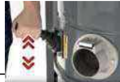
manuelle Abreinigung Filterabreinigung
